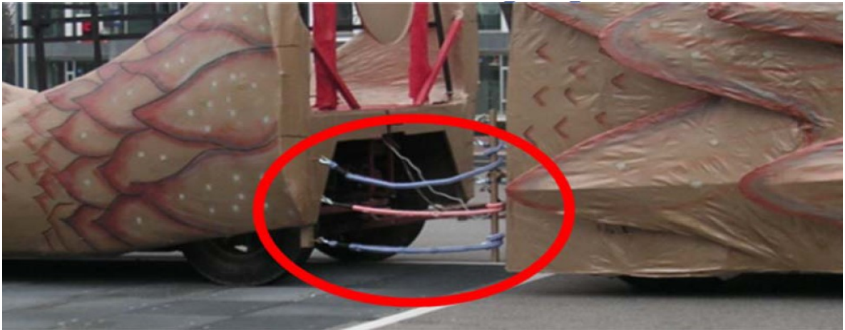
Eine gute Sicherung mit Gummiseilen zwischen Zugfahrzeug und Anhänger.
